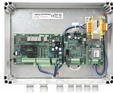
Gateway digitale per il collegamento di ingressi digitali quali: contatti ausiliari di quadri elettrici, stato di interruttori di media tensione, ecc.
